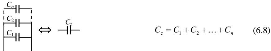
Rys. 6.6. Połączenie równoległe kondensatorów, pojemność zastępcza
